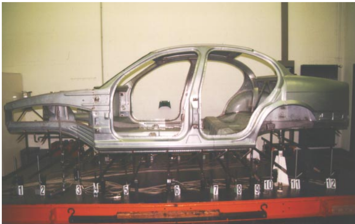
Figure 10.3.2.1-1 DH on Test Rig for Static Torsion
